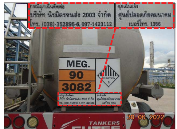
รูปที่ 3.28 ระบบ GPS และหมายเลขโทรศัพท์ติดที่รถขนส่งกากของเสีย (กรณีมีเหตุฉุกเฉินดำเนินการประสานกับทางโครงการพร้อมกับบรรจรับเหตุในทันที)
